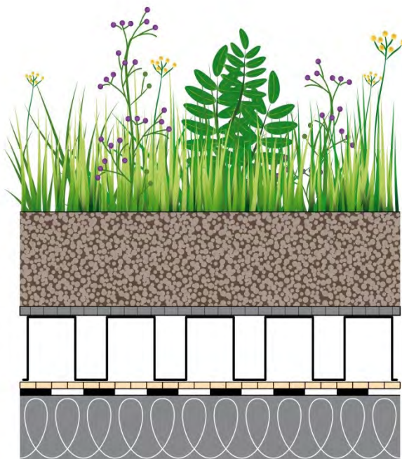
Gründach-Aufbau in mehrschichtiger Bauweise
