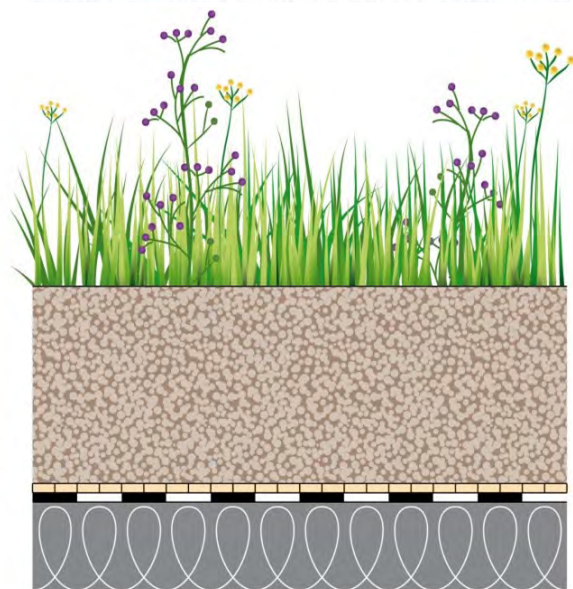
Gründach-Aufbau in einschichtiger Bauweise
